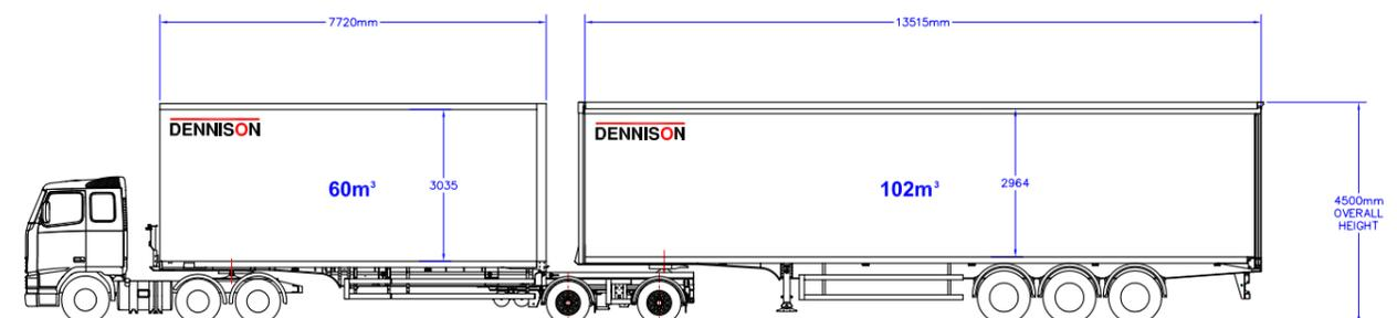
COMPRIMENTO TOTAL PONTO DE CARREGAMENTO = 7720 mm + 13 515 mm = 21,2 m
